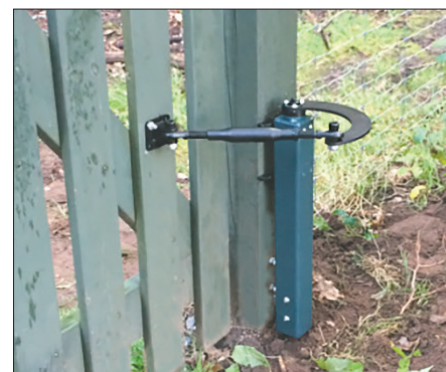
Här ses själva grindöppnaren monterad på stängselstolpen.
